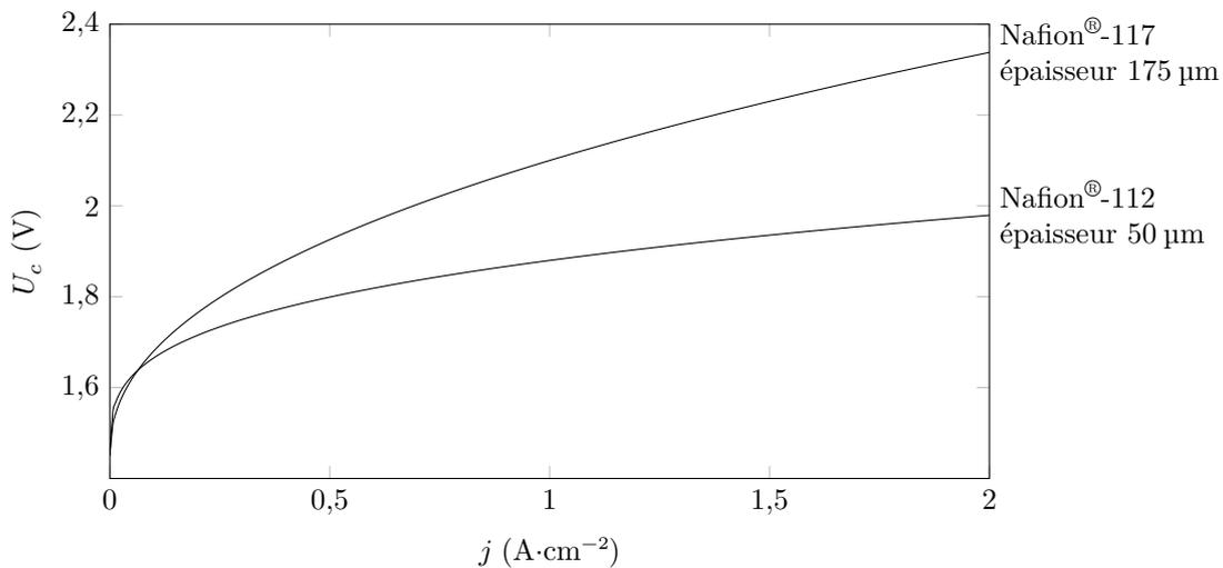
Figure 7 Caractéristique  $U_c = f(j)$  pour 2 membranes polymères différentes
