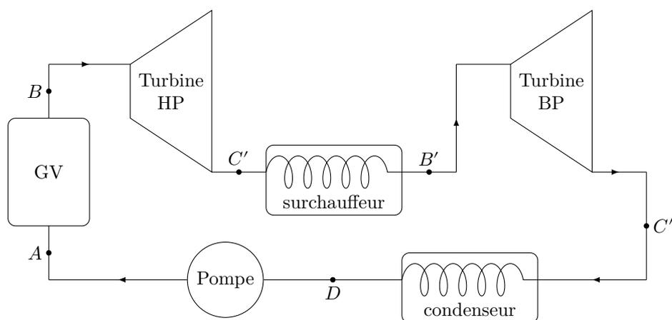
Figure 3 Cycle de Rankine avec une détente étagée
