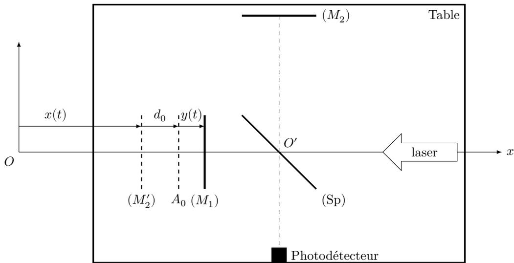
**Figure 9** Interféromètre de Michelson dans un sismomètre optique
