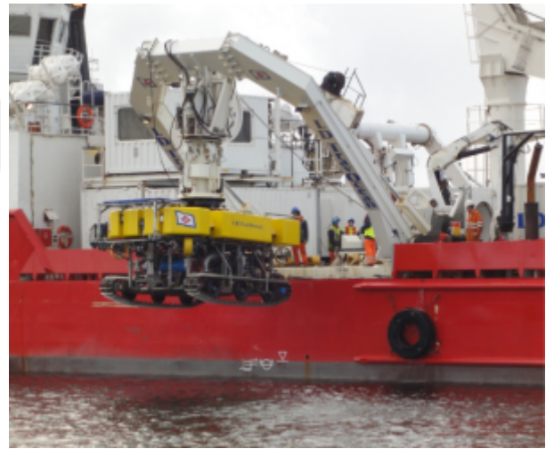
Figure 3 ROV suspendu à la grue portique
