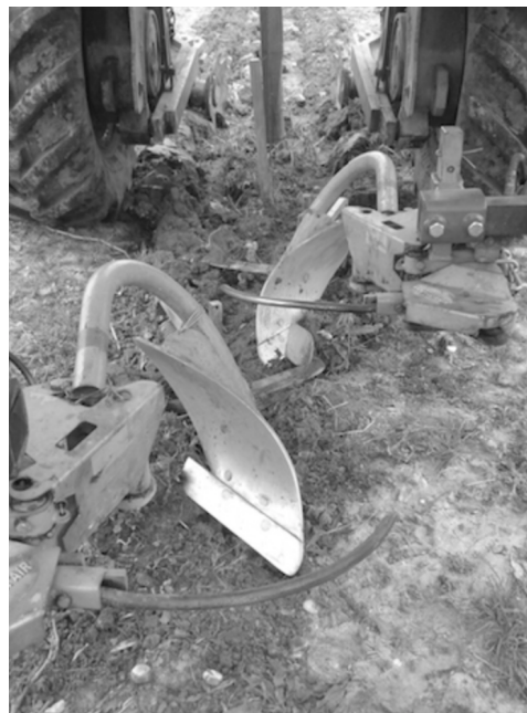
Figure 2 Lames décavaillonneuses interceps équipant un enjambeur
