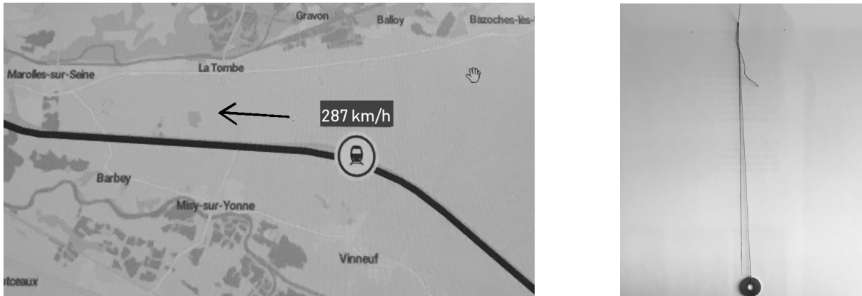
Figure 5 La carte permet d'estimer que le rayon de courbure du virage lors de la réalisation de l'expérience est R_c = 4 km. Sur la photo à droite, le segment noir matérialise la verticale lorsque le train est à l'horizontale.
